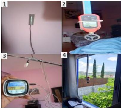
Figura 2.5 (1) Sensor de temperatura. (2) Sensor de velocidad. (3) Prueba de medición de temperatura en el centro de la habitación. (4) Ventana de entrada de viento.
